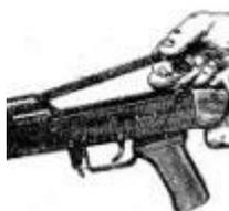
6. Отделить возвратный механизм – он похож на стержень, обмотанный пружинкой. Удерживая автомат левой рукой за шейку приклада, правой рукой подать вперед направляющий стержень возвратного механизма до выхода его пятки из продольного паза ствольной коробки; приподнять задний конец направляющего стержня и извлечь возвратный механизм из канала затворной рамы.
