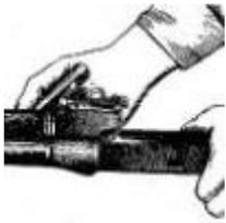
**9. Отделить газовую трубку со ствольной накладкой.** Удерживая автомат левой рукой, правой рукой повернуть замыкатель от себя до вертикального положения и снять газовую трубку с патрубком газовой камеры.
